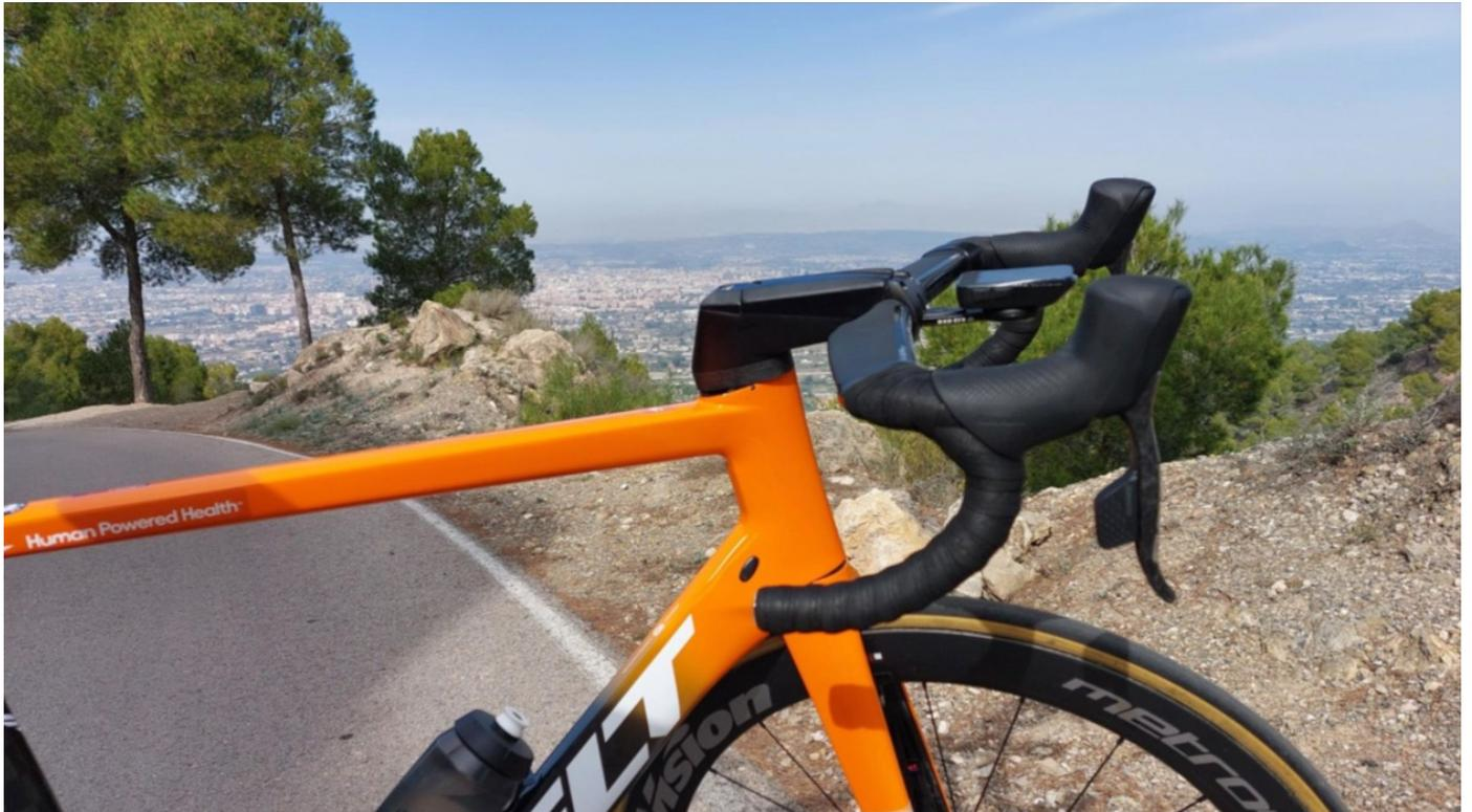
Le bici moderne sono dotate di telai con profili di tubi intricati, forcelle aerodinamicamente ottimizzate e componenti integrati. L'attenzione è rivolta alla diminuzione della resistenza riducendo al minimo l'area frontale o i bordi d'attacco della bici, uniformando il flusso d'aria attorno ad aree chiave come il tubo di sterzo, il manubrio e integrando i cavi dei freni nel telaio per ridurre la turbolenza. Ciò conferisce anche a queste nuove bici un'estetica davvero "pulita" e ordinata.
